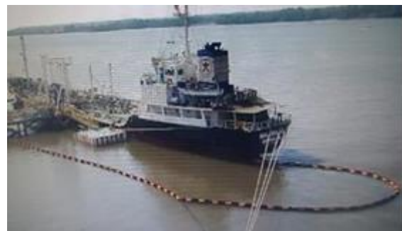
ภาพที่ 8 การล่อมทุ่นดักน้ำมันล่อมรอบเรือ
